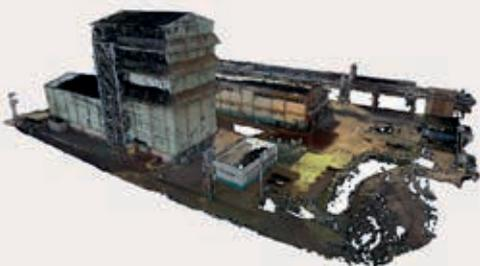
Utilizando escaneio láser 3D, obtenemos modelos digitais precisos y georreferenciados de áreas de interés, facilitando la planificación y control de proyectos mediante la captura, procesamiento y modelado de la instalación.
