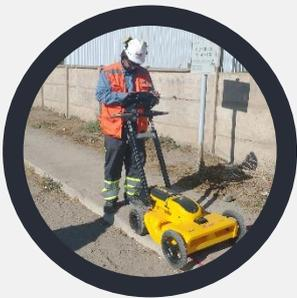
La geodetección es una tecnología que permite localizar servicios o estructuras bajo tierra de manera no invasiva evitando la realización de calicatas u otro tipo de intervenciones destructivas.
